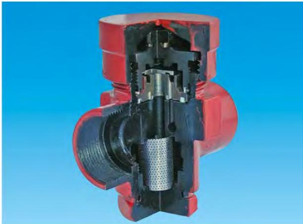
Принцип действия термодинамических конденсатоотводчиков основана на термодинамическом эффекте полученный между седлами и клапанами в результате чего они пропускают за собой только конденсат. Седло и клапан вырабатываются из нержавеющей стали с химическо-термической обработкой и шероховатостью рабочей поверхностей 0,03 мкм.
